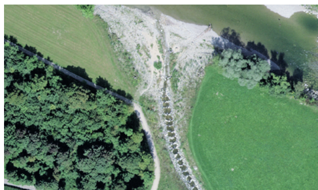
Bild 8: Orthofoto 2023 (links) und 2025 (rechts) Kennzeichnung des früheren Absturzes in Orange. Die Aufweitung im Bereich des Bachdeltas inklusive der Rodung des Waldes ist deutlich sichtbar. Im Bild links ist ein Foto des Absturzes mit einer Höhe von 4 m vor der Sanierung eingefügt. Quelle: map.geo.admin.ch.
