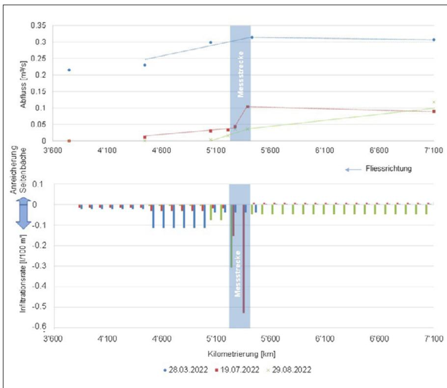
**Bild 9:** Oben: Wassermengen im Längsverlauf zwischen km 7'200 und km 3'600. Messungen im Juli und August 2022 mit einer Genauigkeit von ± 10 Prozent. Unten: Versickerung (Infiltration) und Anreicherung entlang der Sissle zwischen km 7'100 und km 3'600.
