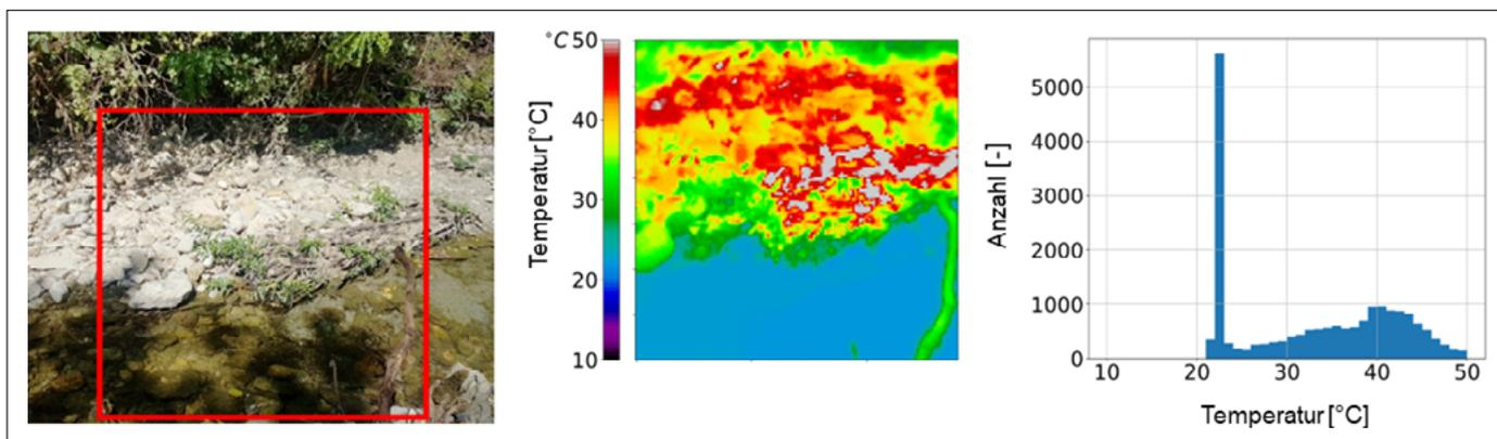
Bild 5: Beispielbild einer Infrarotaufnahme: Das rot eingetragene Quadrat zeigt den gewählten Ausschnitt, welcher mit der Wärmebildkamera aufgenommen wurde. Das mittlere Bild zeigt die Infrarotaufnahme des Abschnitts. Gut zu erkennen ist die kühlere benetzte Fläche (blau). Das Histogramm zeigt die Verteilung der Anzahl Pixel der jeweiligen Temperatur.
