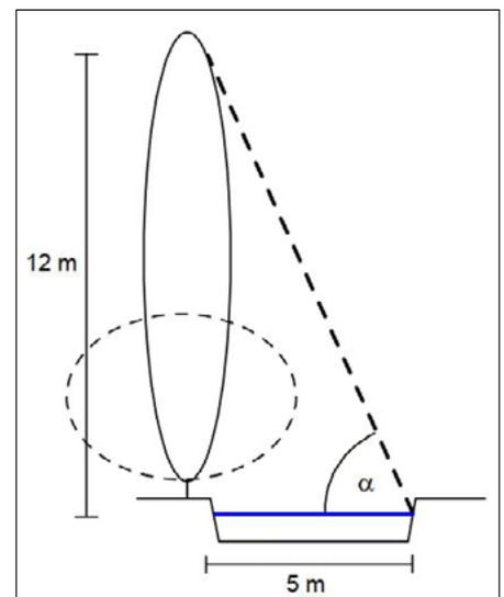
**Bild 15:** Bei einem Sonnenwinkel  $\alpha$  von  $67^\circ$  über der Horizontalen ist bei einer Sohlbreite von 5 m eine Höhe der Bepflanzung von rund 12 m notwendig (*Moosmann, Schmid, Wüest, 2005*).
