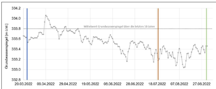
**Bild 10:** Kantonale Grundwassermessstelle Neumatt II in Frick, mit Eintrag der Messtage der Wassermengenmessung.
